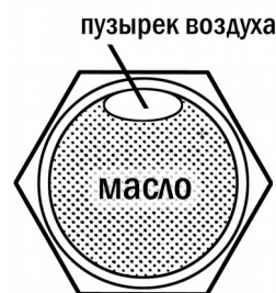
Рис 3: Воздушный пузырек в смотровом окошке
